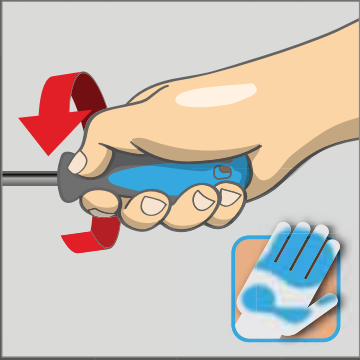
Amplia zona de contacto de las manos = más potencia de torque
