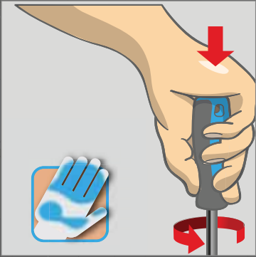
Amplia zona de contacto de las manos = más potencia de torque
